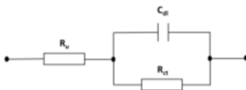
Gambar 2. Skema sirkuit listrik ekuivalen yang digunakan dalam pengukuran R_u . R_u adalah resistivitas cairan ion, C_{dl} adalah kapasitansi lapis rangkap listrik, R_{ct} adalah resistivitas transfer elektron.
