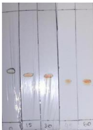
Gambar 2 Hasil analisis KLT astaxanthin standar (0 menit) dan kompleks Zn-astaxanthin (15, 30, 45, 60 menit) dengan fasa gerak atau eluen berupa campuran heksana dan aseton (3:1 v/v)
