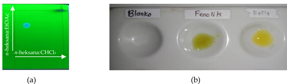
Gambar 3. a) KLT isolat dengan KLT 2 dimensi dan b) hasil uji fenolik isolat
