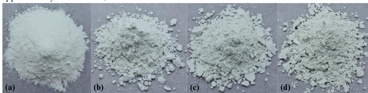
Figure 1. Synthesized TiO 2 a) TiO 2 -C, b) TiO 2 -5mL, c) TiO 2 -10mL, d) TiO 2 -15mL
